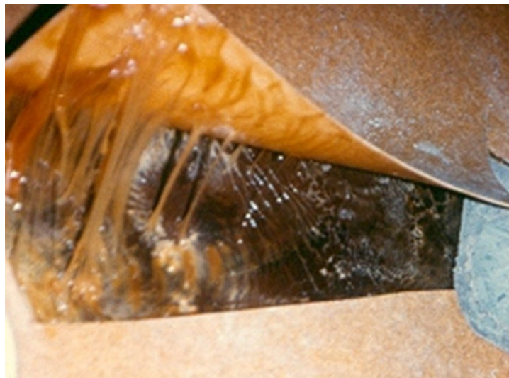
Fig. 2 Nedbrytning av lim genom alkalisk hydrolys som resulterat i förtvålning.
