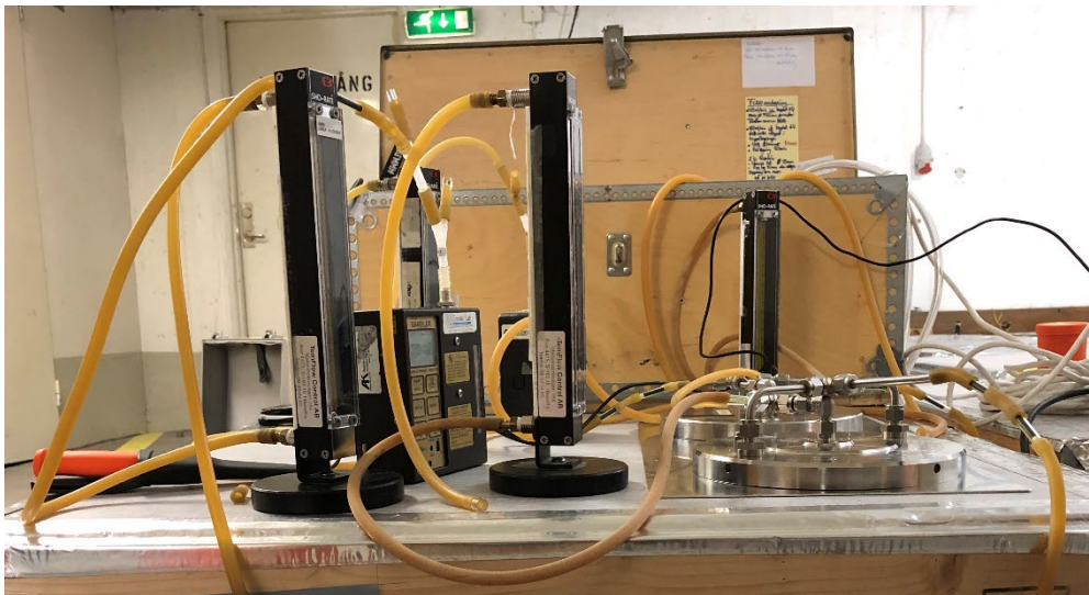
Fig. 1 Emissionsmätning ovanpå ytskikt, förberedelser genom referensmätning mot stålplatta, s.k. bakgrundsmätning.
